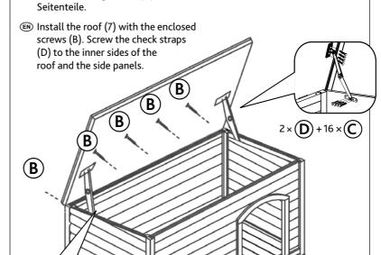
© Befestigen Sie das Dach (7) mit den Schrauben (B). Verschrauben Sie die beiden Fangbänder (D) an den Innenseiten des Daches und der
